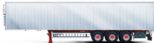
Foto 1: De Knapen Cargo Walk K200: Het 'topmodel' zelfdragende schuifvloeroplegger van Knapen Trailers BV.
